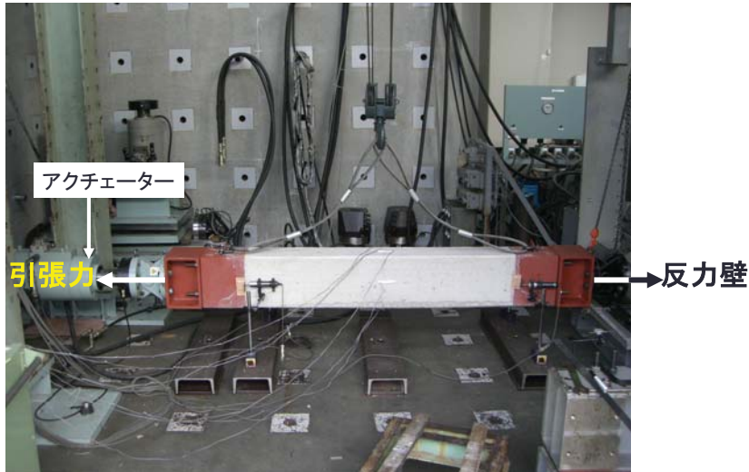
写真 直接引張試験(実験状況)
