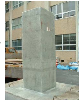
写真 曲げ降伏している柱
