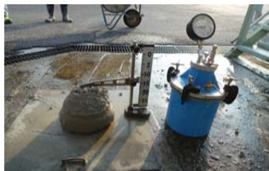
工場出荷時 性状試験 SL:13.5cm 空気量:4.8% GT:28.0°C AT:27.0°C
