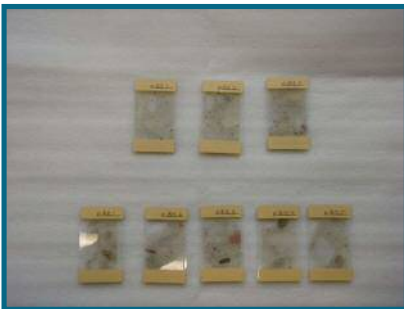
コンクリート薄片試料の作製
